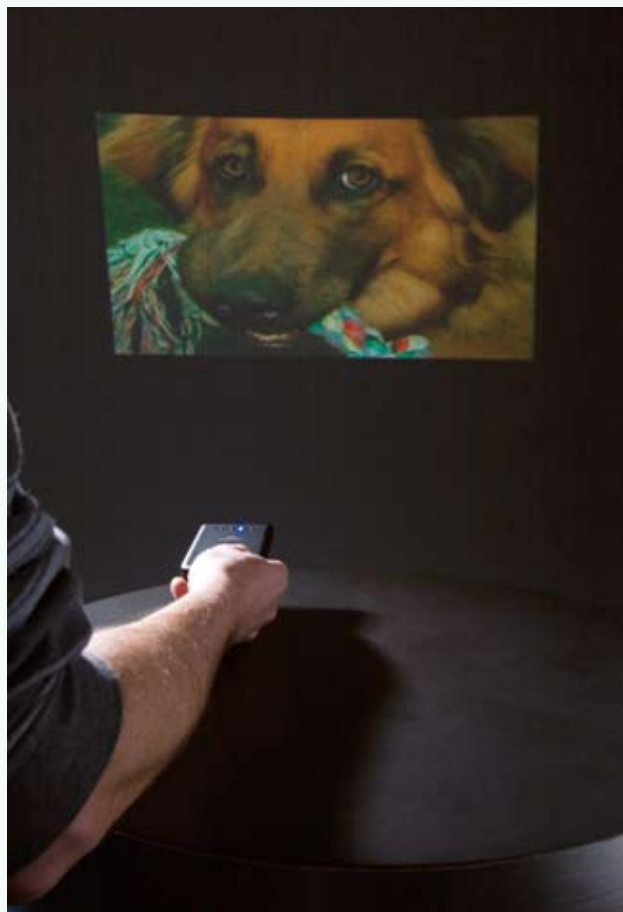
採用二軸MEMS掃描儀和雷射光源的嵌入式超小型投影機，可應用於手機、PDA以及數位相機等行動裝置。
